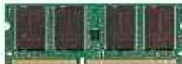
144 pin SDRAM SODIMM
